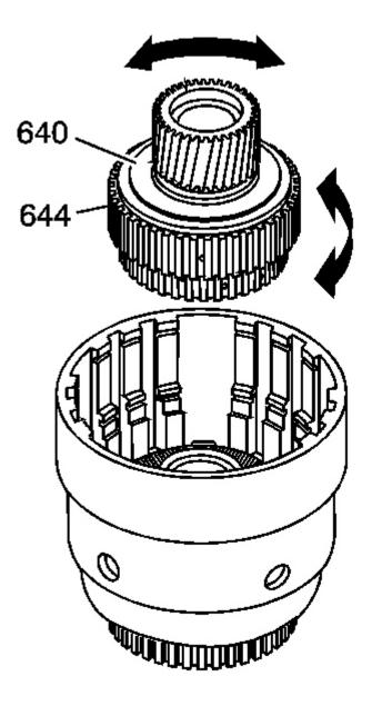
Fig. 175: Checking Sun Gear Rotation
